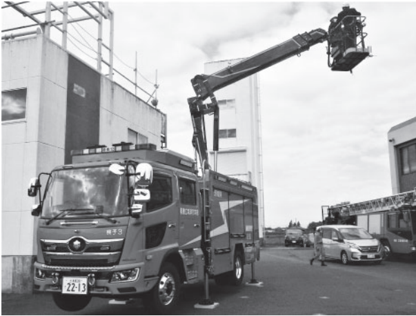
13m ブーム付多目的消防ポンプ自動車
