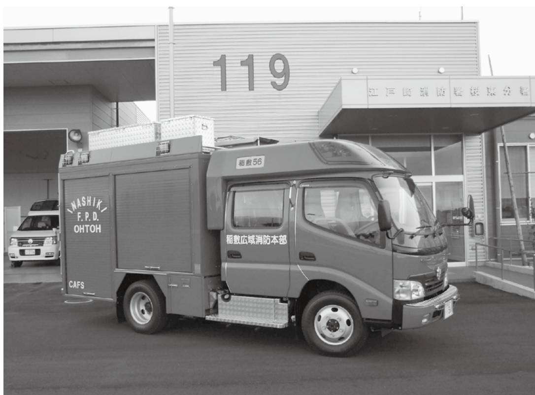
『平成23年1月に更新した消防ポンプ自動車（圧縮空気泡消火装置搭載）』
